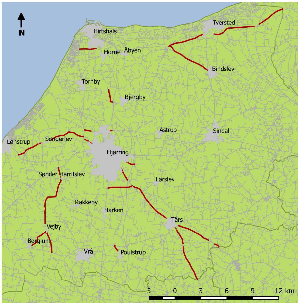
Figur 11.1: Testvejnet i Hjørring Kommune bestående af 65 km fordelt på 62 strækninger. (Grundkortet indeholder data fra Geodatastyrelsen og Danske Kommuner, FOT-data, juli 2014)
