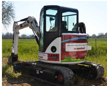
Figure 3.1. 5t mini-excavator equipped with Walvoil ALS
